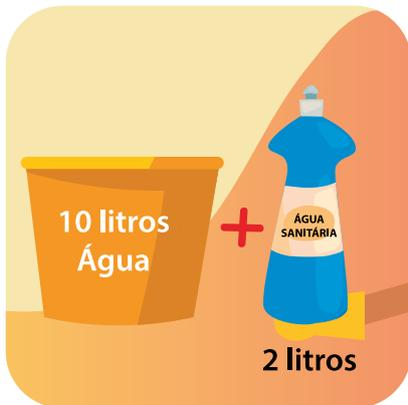
**5** Quando a caixa estiver seca, adicione água limpa (aproximadamente 10 litros de água) e acrescente dois litros de água sanitária comercial (proporção para uma caixa de 1.000 l). Deixe repousar por duas horas, lembrando de a cada 30 minutos molhar as paredes internas da caixa e a tampa
